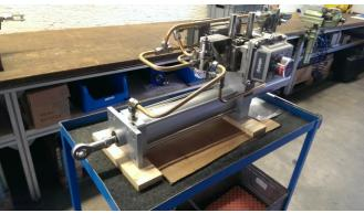
Ausführung mit geringer Reibung und dichtem Kolbenabschluß bei Drücken bis maximal 10 barü ermöglicht eine hohe Regelgüte unabhängig von der Regelaufgabe.
